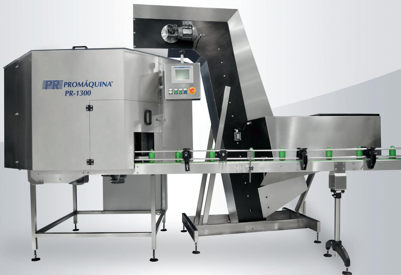
Equipamento desenvolvido para posicionamento de frascos plásticos.
