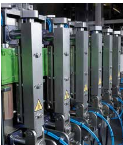
Zona soldaduras verticales con sistema de movimiento en paralelo. Parallel motion vertical sealing bars.
