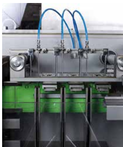
Grupo de corte de bolsas con triple hoja para corte de bolsas con forma parcial. Triple scissor pouch cutting group to form partial shaped pouches.
