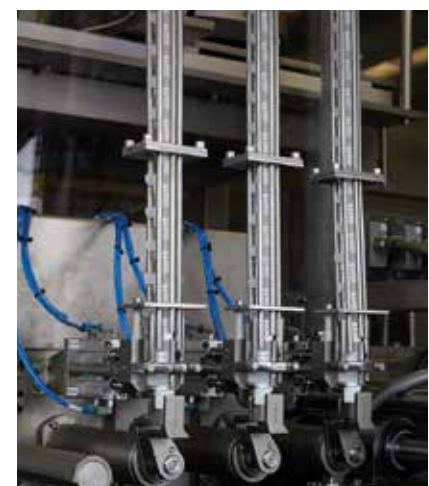
Guías y grupos paso a paso para alimentación válvulas con pinzas de inserción válvulas accionadas mediante servo. Guide rails and sequential grouping to feed valves with servo-controlled valve insertion finger clamps.
